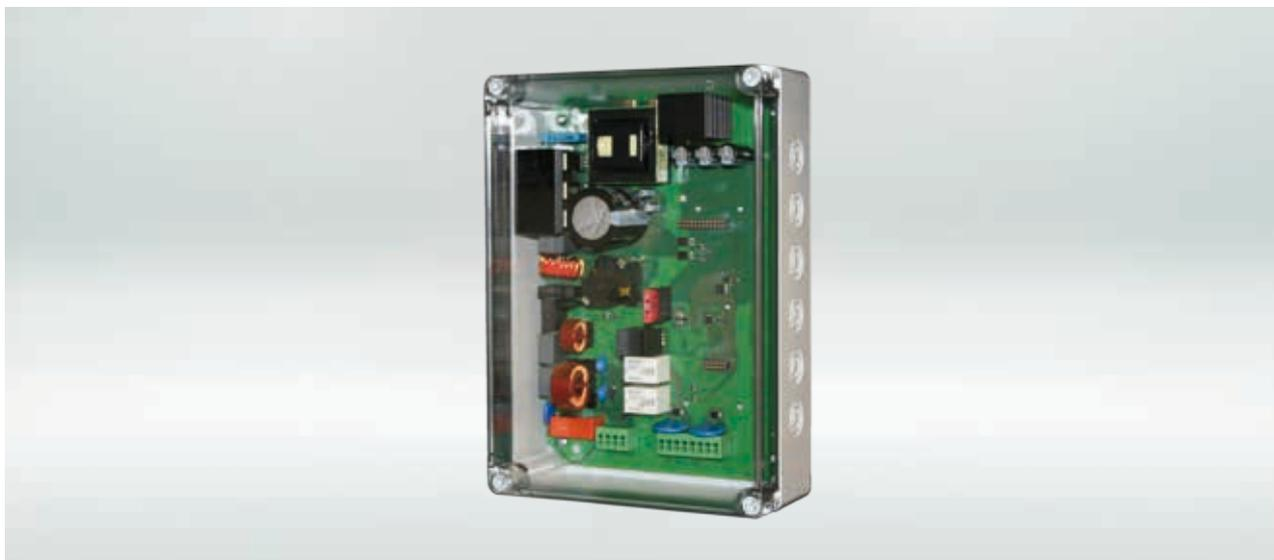
Lüftungszentrale zur Steuerung von 24 V DC Antrieben mit einer Stromaufnahme von bis zu 8A.
