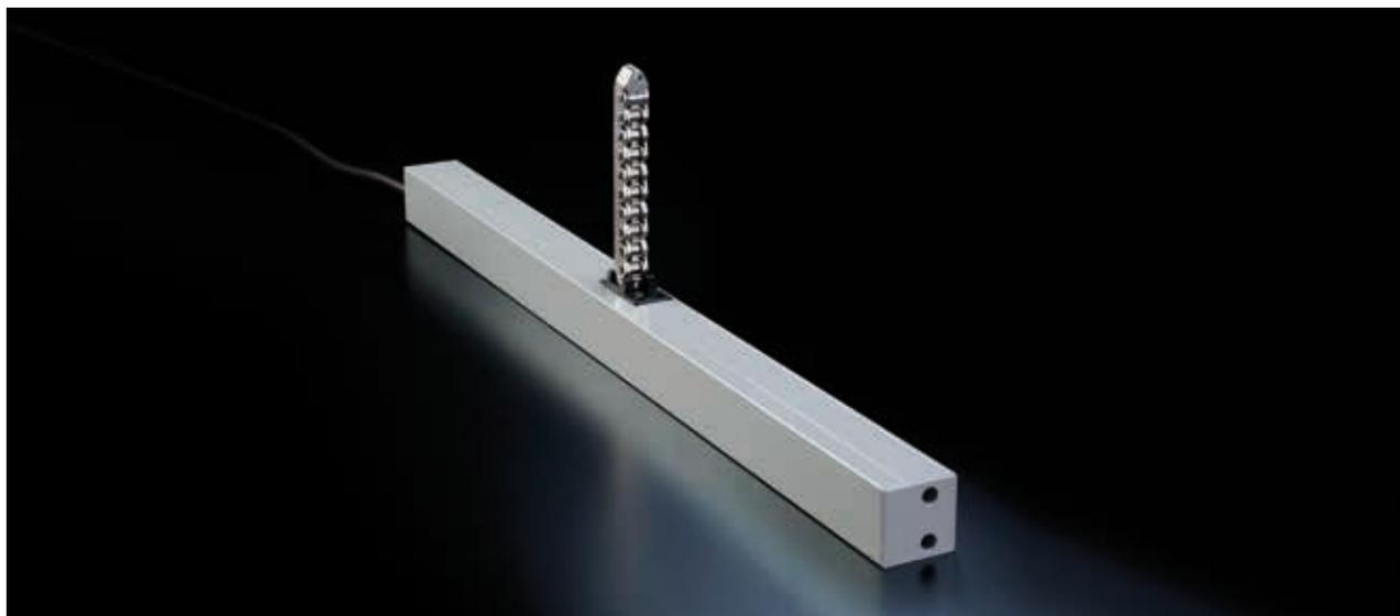
Mit 300 N Zug- und Druckkraft ist der EM AC mit 230 V ein Universalantrieb für den mittleren Leistungsbereich. Durch seine geringe Bautiefe eignet er sich gut für Anwendungen mit engem Montageaum, z. B. auch vor Beschattungen. Durch seine geradlinige Formgestaltung passt er sich optisch unauffällig an Fenster- und Fassadenprofile an. Der EM AC verfügt über ein integriertes Vorschaltgerät und wird mit 230 V Netzspannung betrieben.
