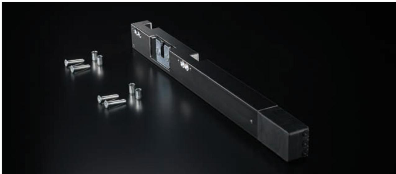
Sehr kleiner Verriegelungsantrieb für die profilintegrierte Montage als beschlagtechnische Ergänzung von EasyDrive/2-Kettenantrieben. Der Verriegelungsantrieb greift mit einem Mitnehmer auf den Fensterbeschlag zu und entriegelt diesen, bevor der Kettenantrieb den Flügel aufstellt. Eine integrierte Folgesteuerung sorgt für die korrekte Betätigungsreihenfolge beim Öffnen und Schließen. Erhältlich als RM mini und RM mini EasyDrive/2.
