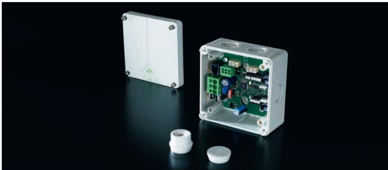
Das Synchronmodul SM3 ist eine mikroprozessorgesteuerte Gleichlauf- und Abschaltsteuerung für die gleichzeitige Betätigung zweier Rauchabzugs- und/oder Lüftungsantriebe 24 V DC an einem Öffnungselement (Flügel/Kuppel usw.). Die Ausführung des Synchronmoduls wird durch die Anwendung und die Stromaufnahme der Antriebe bestimmt.
