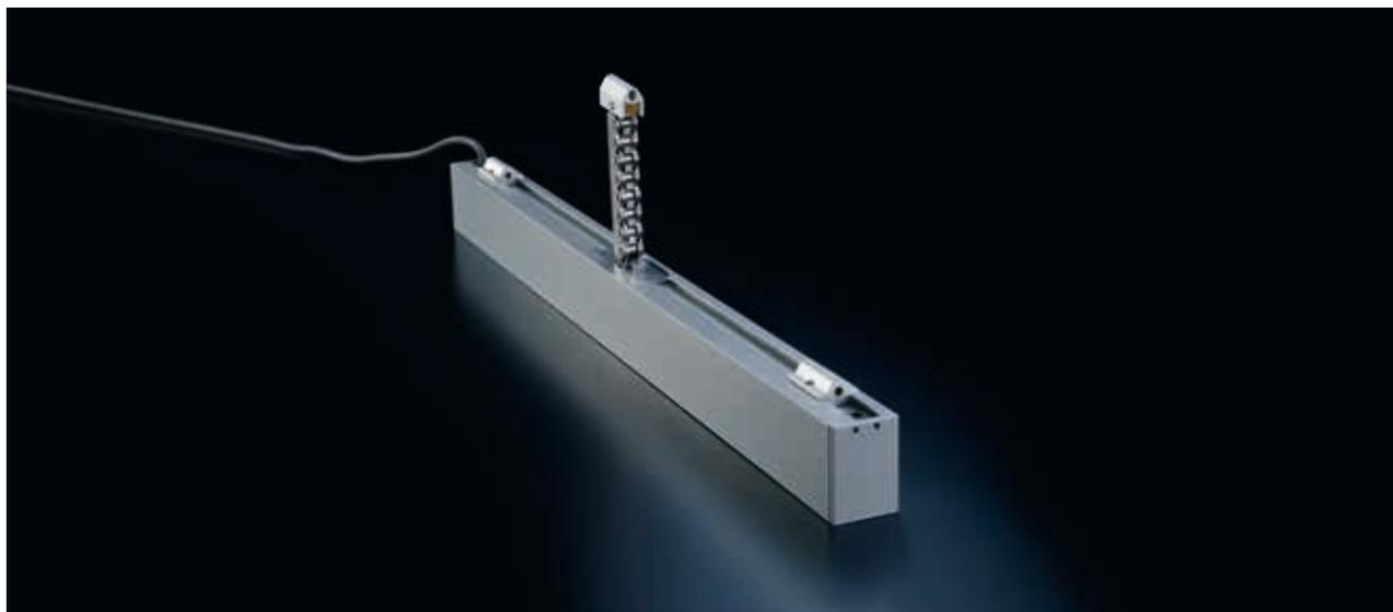
Die Antriebe der CM-Serie verfügen über eine hohe Kraft bis 600 N bei einer gleichzeitig schlanken, gradlinigen Bauform. Alle Konsolen und Anschlüsse befinden sich in einer Installationsebene auf der nicht einsehbaren Seite hinter dem Antrieb. Die Konsolen lassen sich am Antrieb durch Verschieben variabel positionieren, das vereinfacht die Montage.
