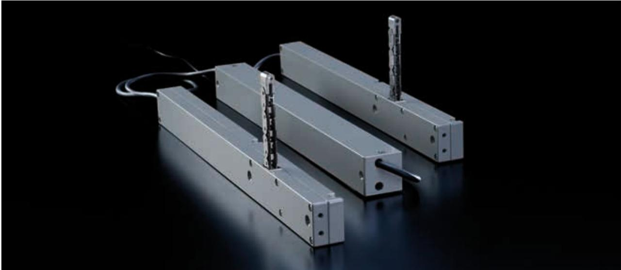
Vielseitig einsetzbare 230 V Antriebslösung mit zwei LM/2 Antrieben mit bis zu 2 x 200 N Druck- und Zugkraft für breite Flügel, Klappen und Oberlichter. Die Ansteuerung erfolgt über eine externe Vorschalteneinheit.
