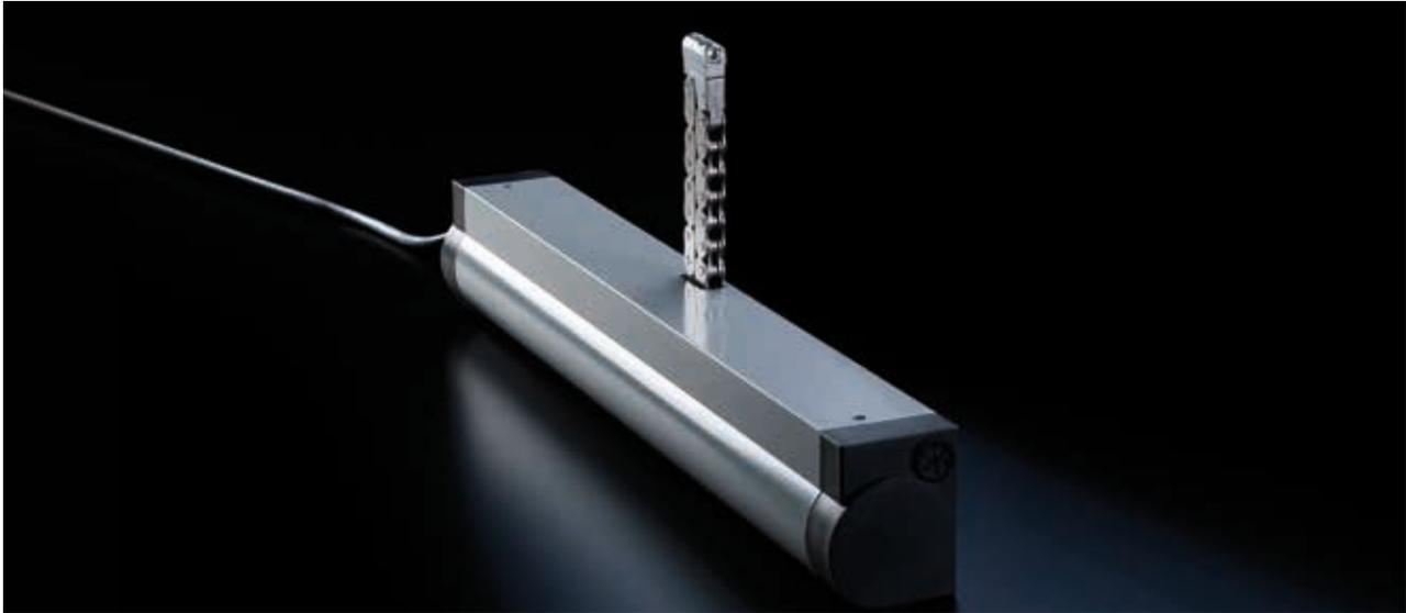
Der FM 309-401 besitzt eine Doppelkette, die sich wie bei einem Reißverschluss zusammenfügt und verzahnt. Dadurch besitzen die Antriebe eine sehr hohe mechanische Stabilität bei flachem Kettenaufbau. Damit lassen sich auch Öffnungselemente mit einem geringen Blendrahmenfreimaß motorisch betätigen. Durch seinen kräftigen und geräuscharmen Antrieb sowie seine besondere Form ist er gut für Anwendungen mit höheren Komfortanforderungen geeignet, z. B. auch in Wintergärten.
