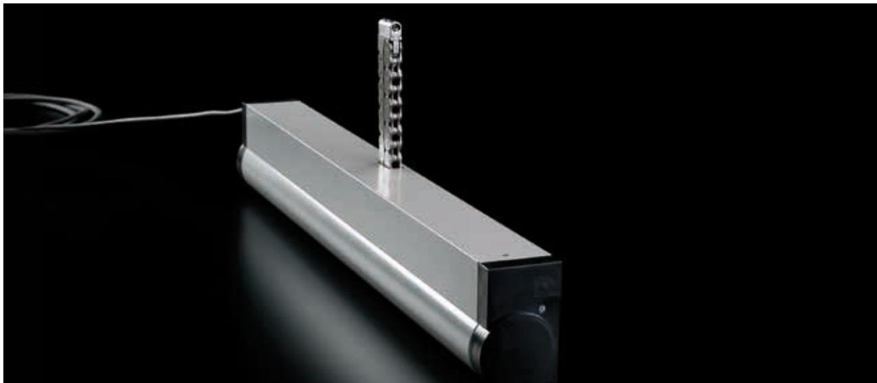
Der FM 501-800 besitzt eine Doppelkette, die sich wie bei einem Reißverschluss zusammenfügt und verzahnt. Dadurch ergibt sich auch im ausgefahrenen Zustand der Kette eine hohe Stabilität nach allen Seiten, trotzdem ist die Kette flexibel und erlaubt in vielen Fällen eine feste Montage des Antriebs ohne weitere Schwenkkonsolen. Der Dichtschluss des Antriebs ist mechanisch einstellbar. Durch seinen geräuscharmen Lauf ist er auch für den Einsatz in akustisch sensiblen Umgebungen geeignet.
