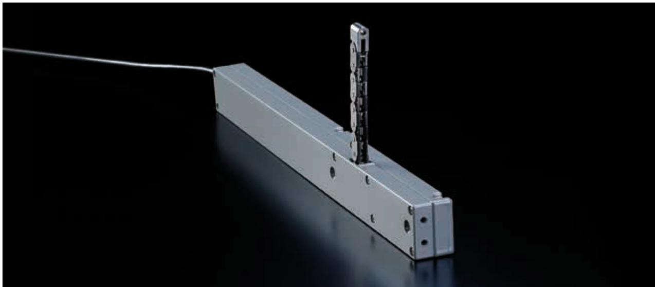
Durch seine schlanke Bauform ist der LM in vielen Fällen verdeckt montierbar. Darüber hinaus ist die Montage auch in beengten Verhältnissen möglich, da kein Schwenkbereich benötigt wird. Durch vielseitige Befestigungsmöglichkeiten ist der Antrieb mit Druck-/Zugkräften bis 200 N variabel einsetzbar. Der LM AC verfügt über ein integriertes Vorschaltgerät und wird mit 230 V Netzspannung betrieben.
