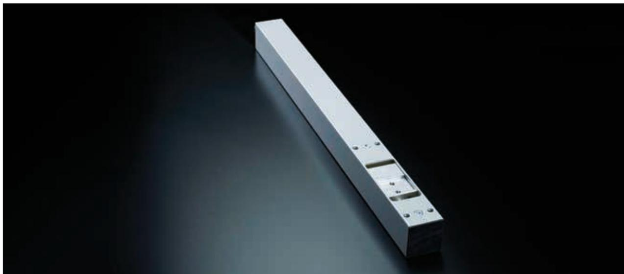
Schlanker Verriegelungsantrieb für die aufgesetzte oder profilintegrierte Montage als beschlagtechnische Ergänzung von EasyDrive/2-Kettenantrieben. Der Verriegelungsantrieb greift mit einem Mitnehmer auf den Fensterbeschlag zu und entriegelt diesen, bevor der Kettenantrieb den Flügel aufstellt. Eine integrierte Folgesteuerung sorgt für die korrekte Betätigungsreihenfolge beim Öffnen und Schließen.
