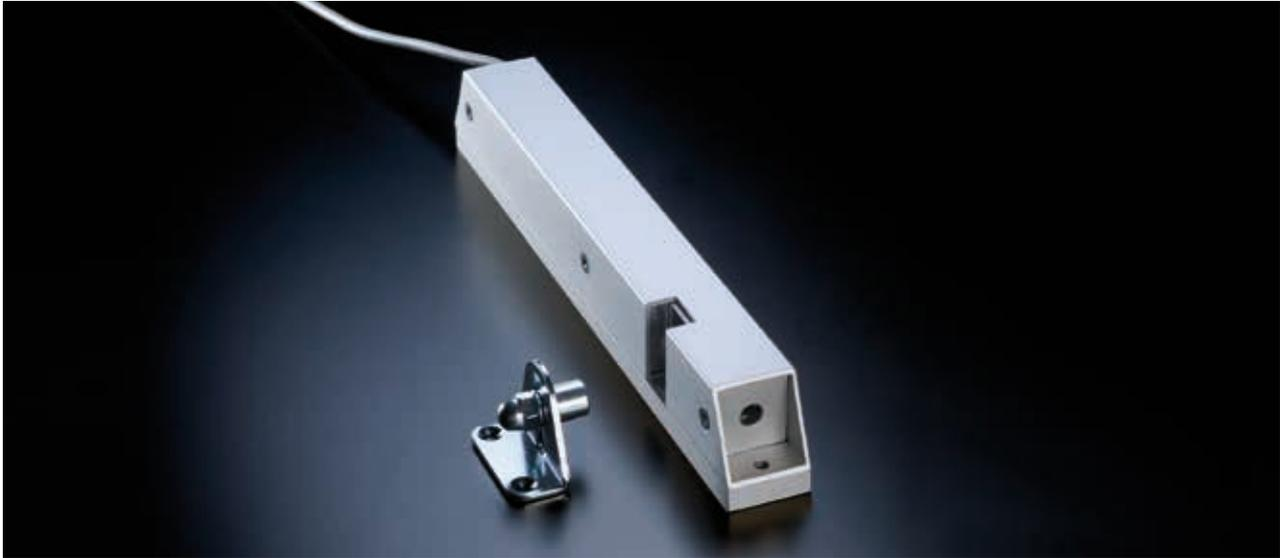
Die elektromotorische Zusatzverriegelung wird in Verbindung mit Linearantrieben an großen Flügeln ohne eigenen Beschlag eingesetzt. Mit ihrer Hilfe erhält man einen zusätzlichen Verriegelungspunkt und stellt bei großen Flügeln einen ausreichenden Dichtschluss sicher. Durch eine zusätzliche mechanische Zweitverriegelung ZWV können so auf einer Flügelseite zwei zusätzliche Verriegelungspunkte erzeugt werden.
