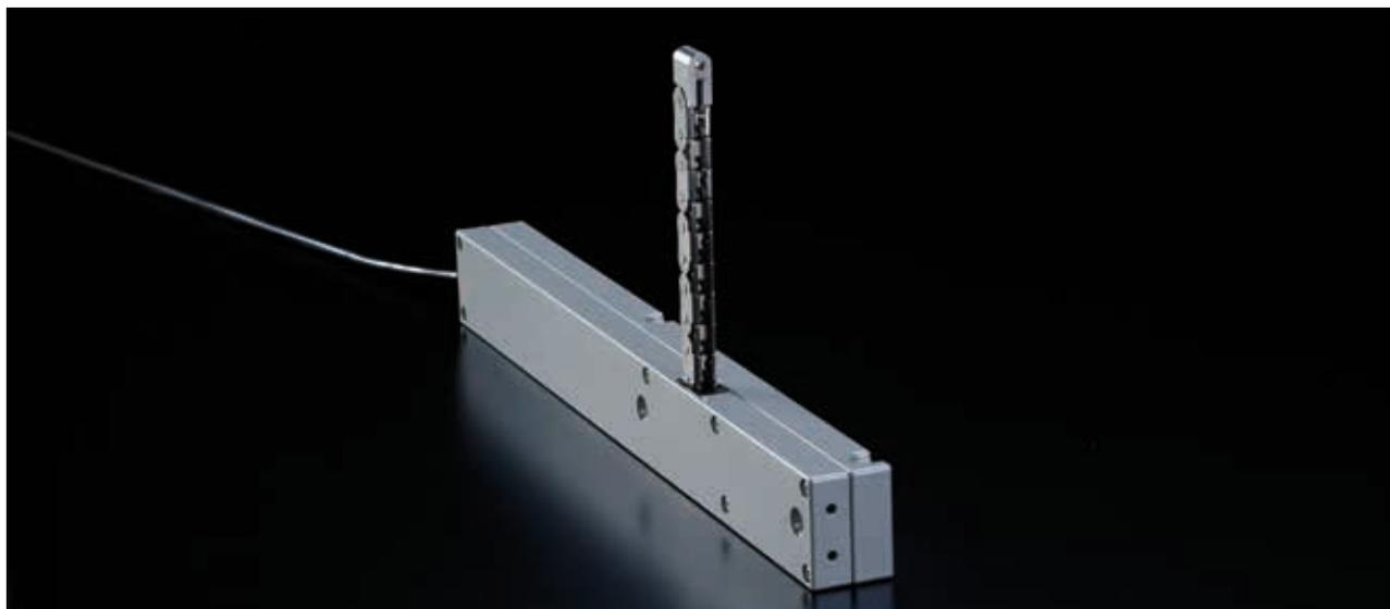
Durch seine schlanke Bauform ist der LM in vielen Fällen verdeckt montierbar. Darüber hinaus ist die Montage auch in beengten Verhältnissen möglich, da kein Schwenkbereich benötigt wird. Durch vielseitige Befestigungsmöglichkeiten ist der Antrieb mit Druck-/Zugkräften bis 200 N variabel einsetzbar. Erhältlich als LM/2 oder als LM/EasyDrive/2.
